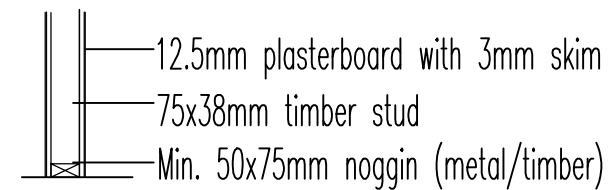
WALL TYPE - WT.04 Stud partition wall
