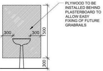
**ELEVATIONS SHOWING EXTENT** OF PLYWOOD BEHIND PLASTERBOARD TO GROUND
