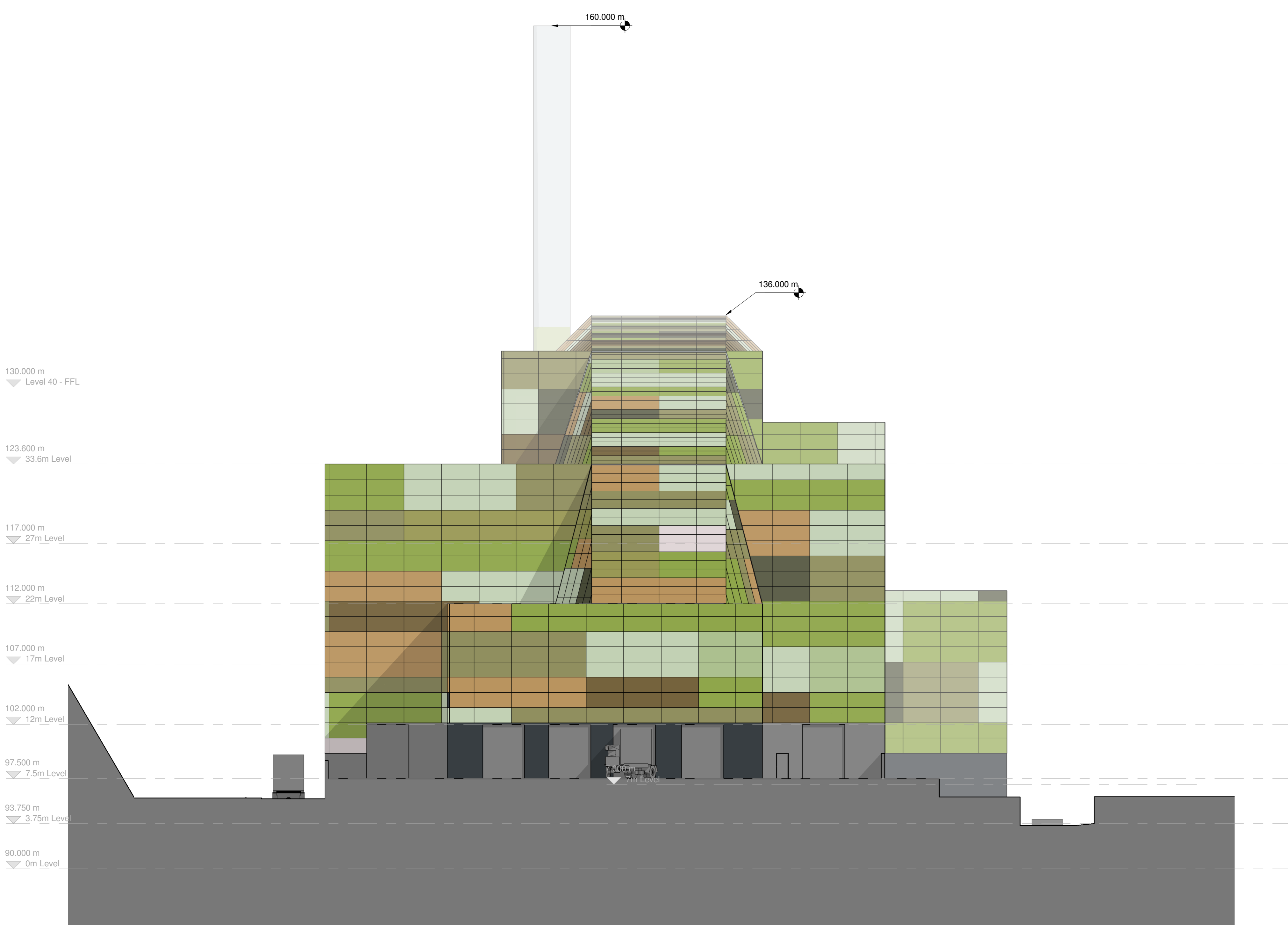
B Elevation EFW&Turbine B 1 : 200
