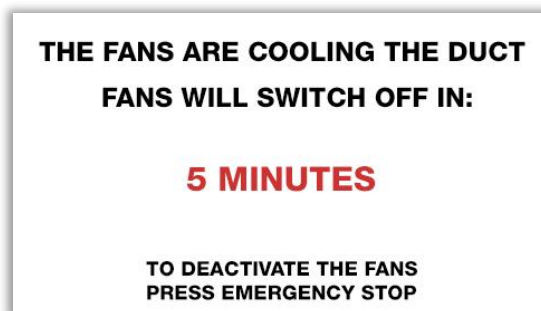
Fig.3.1 Fan Overrun Time
