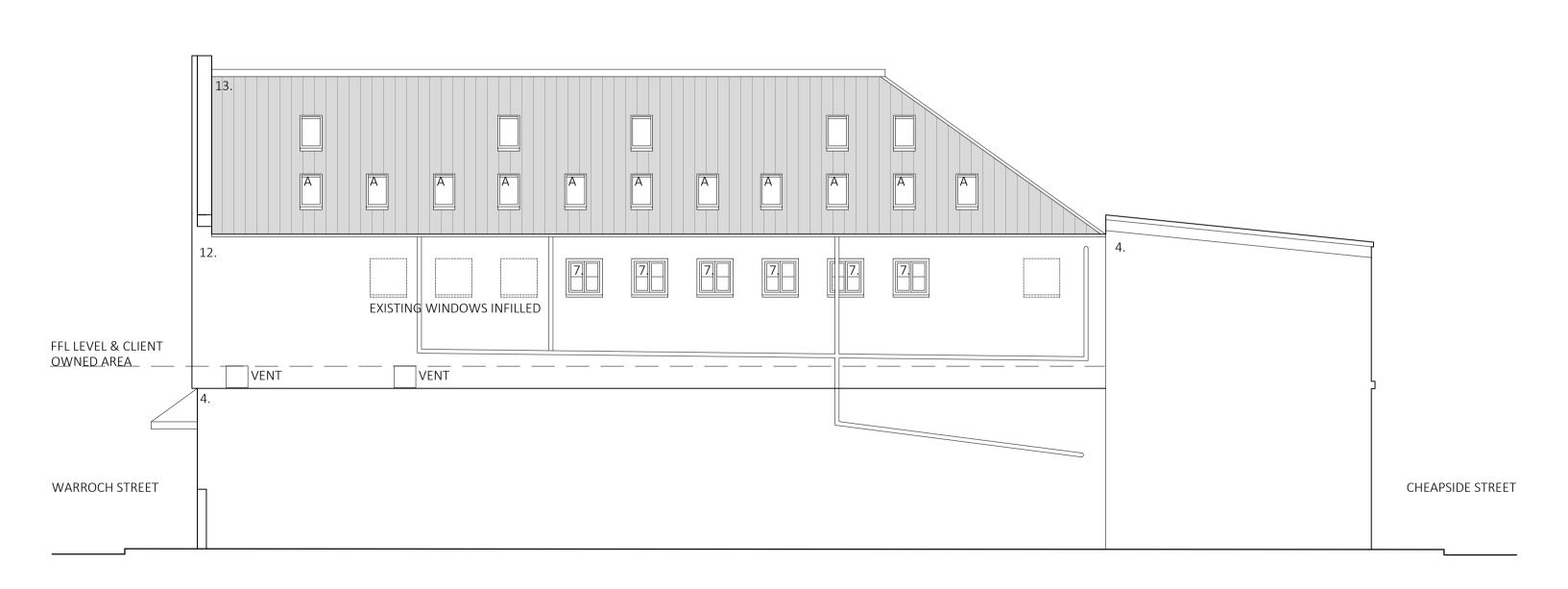
PV PANELS 2. WHITE 2. BLACK NEW SIGNAGE / CANOPY AND CANOPY VENT WARROCH STREET ROLLER NEW GLAZED ROLLER SHUTTER DOOR SHUTTER WEST ELEVATION
