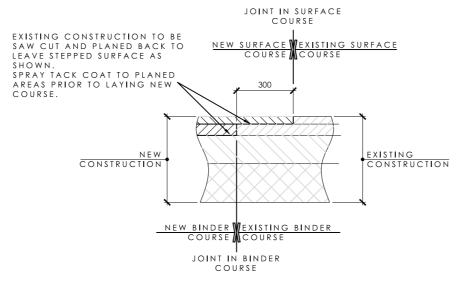
TYPICAL JOINT DETAIL BETWEEN NEW & EXISTING CONSTRUCTION 1:20
