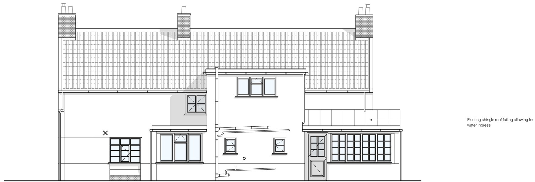
Existing - Elevation - SE 1:100
