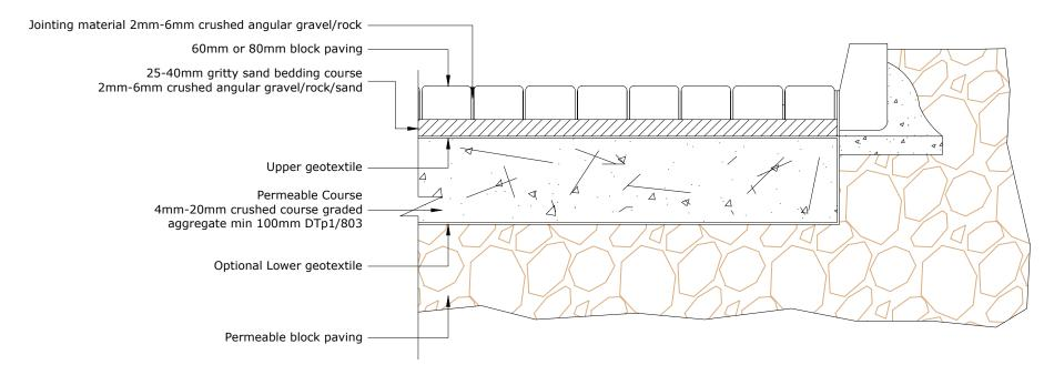
TYPICAL PERMEABLE BLOCK PAVING DETAIL
