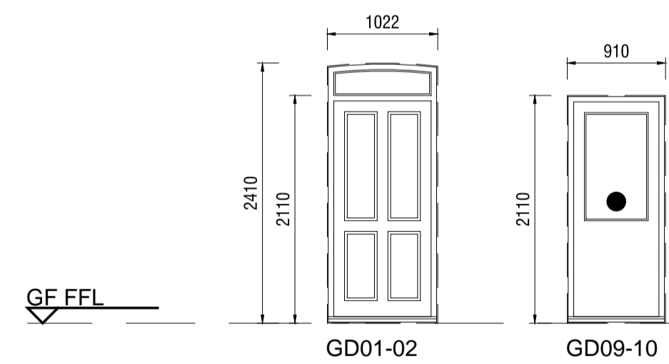
DOOR ELEVATIONS (UNITS 1,2,7)
