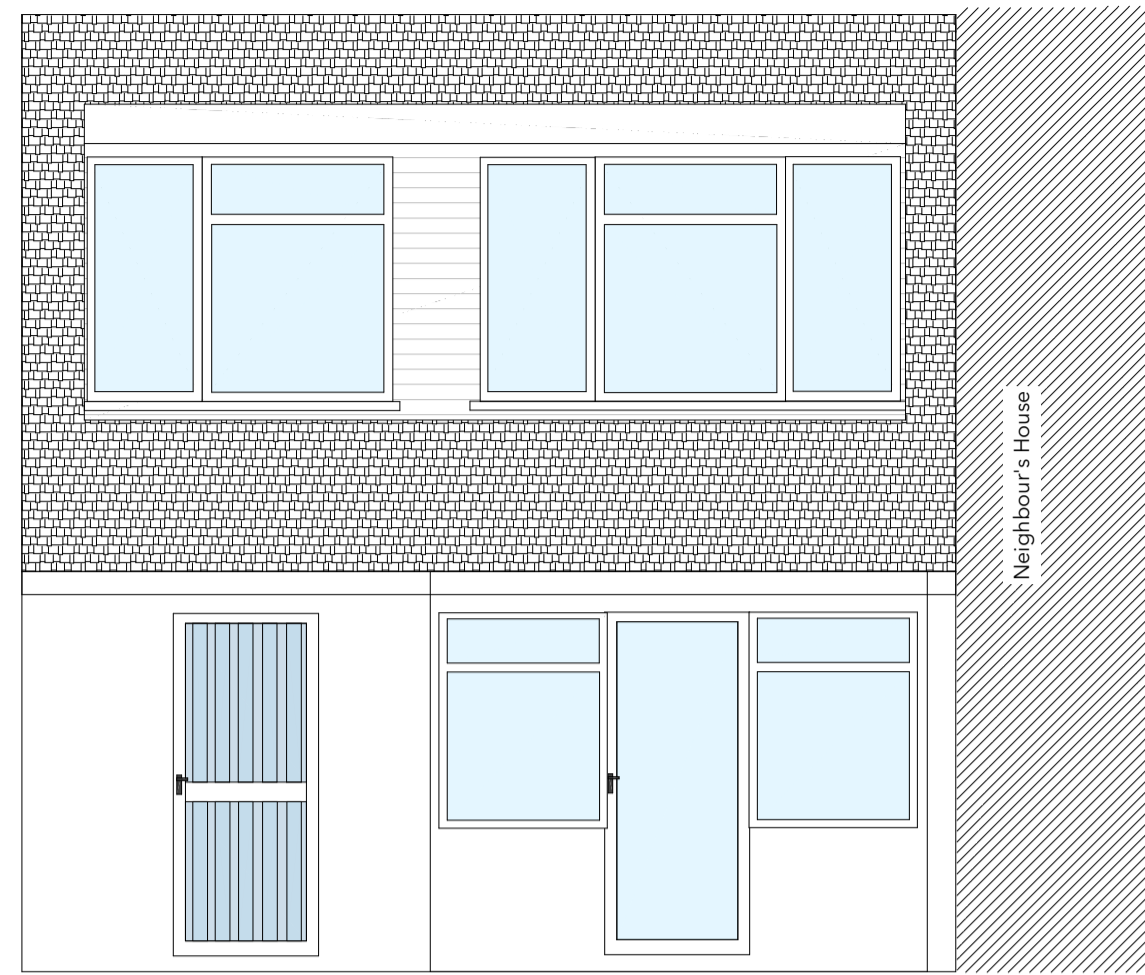
EXISTING REAR ELEVATION Scale: 1:50
