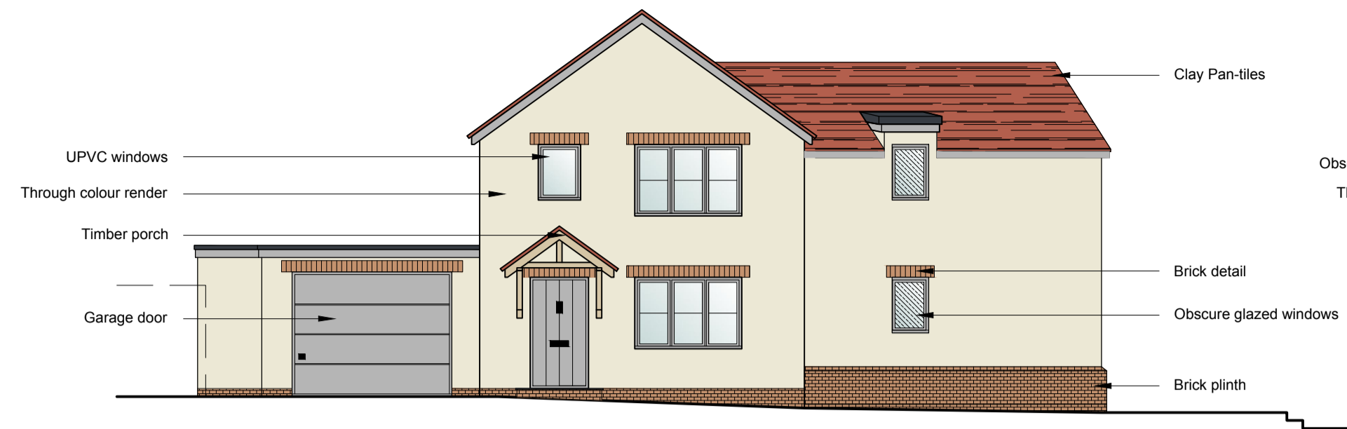
Front Elevation Scale: 1:100
