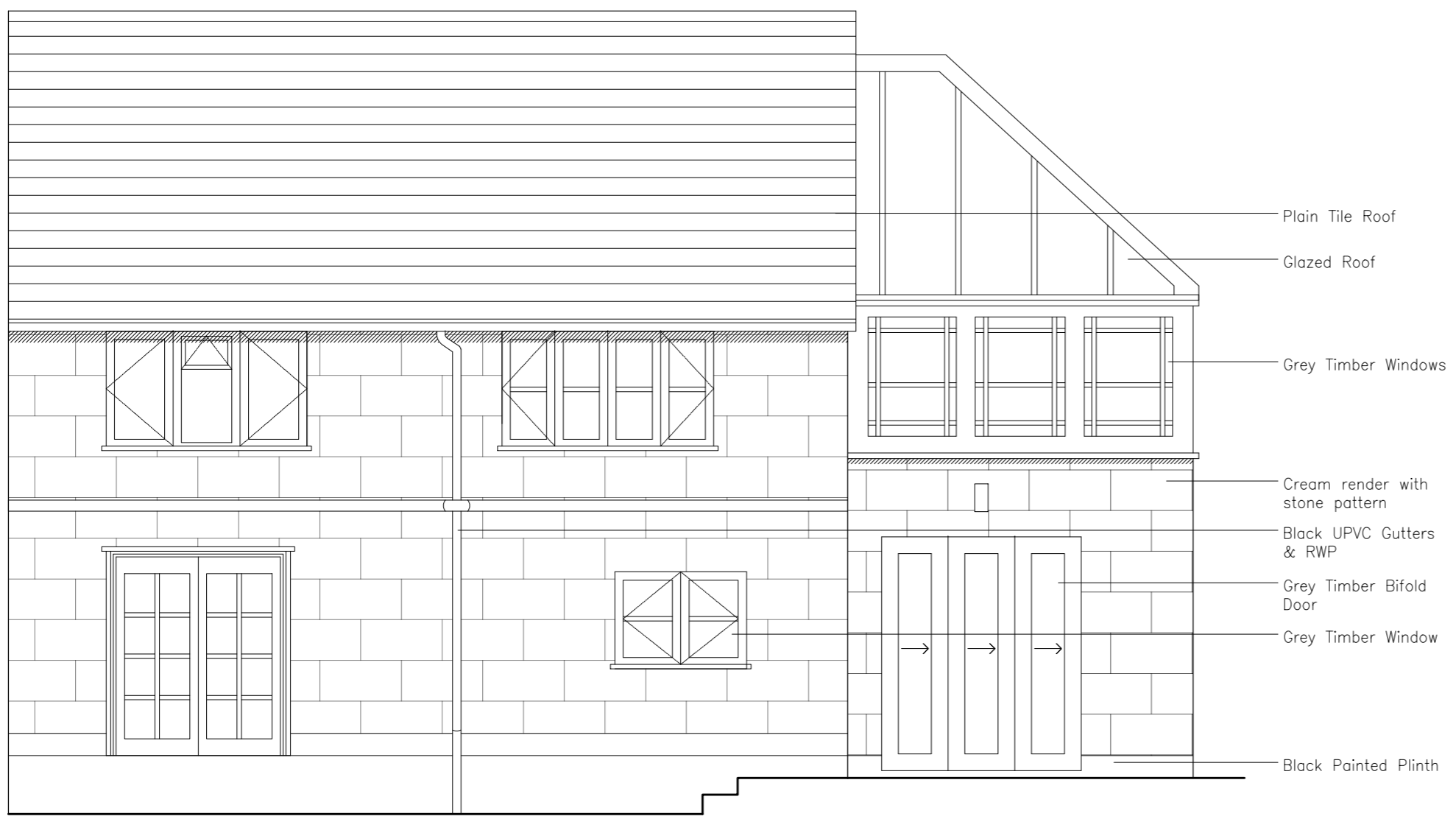
South Elevation Scale: 1:50
