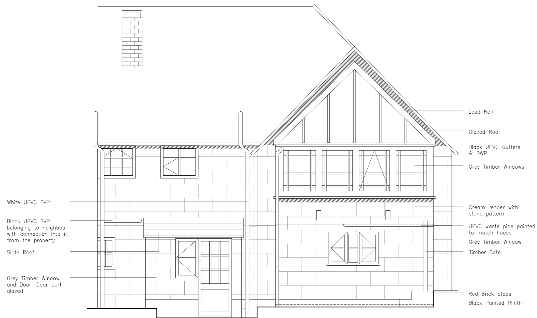
East Elevation Scale: 1:50
