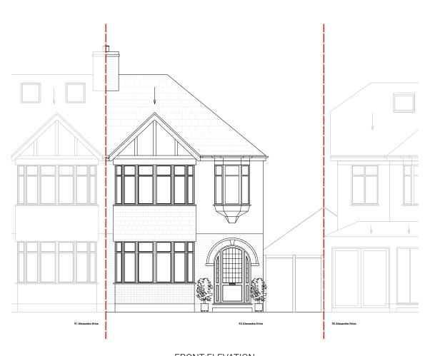
FRONT ELEVATION NO PLANNED WORKS ON THIS ELEVATION
