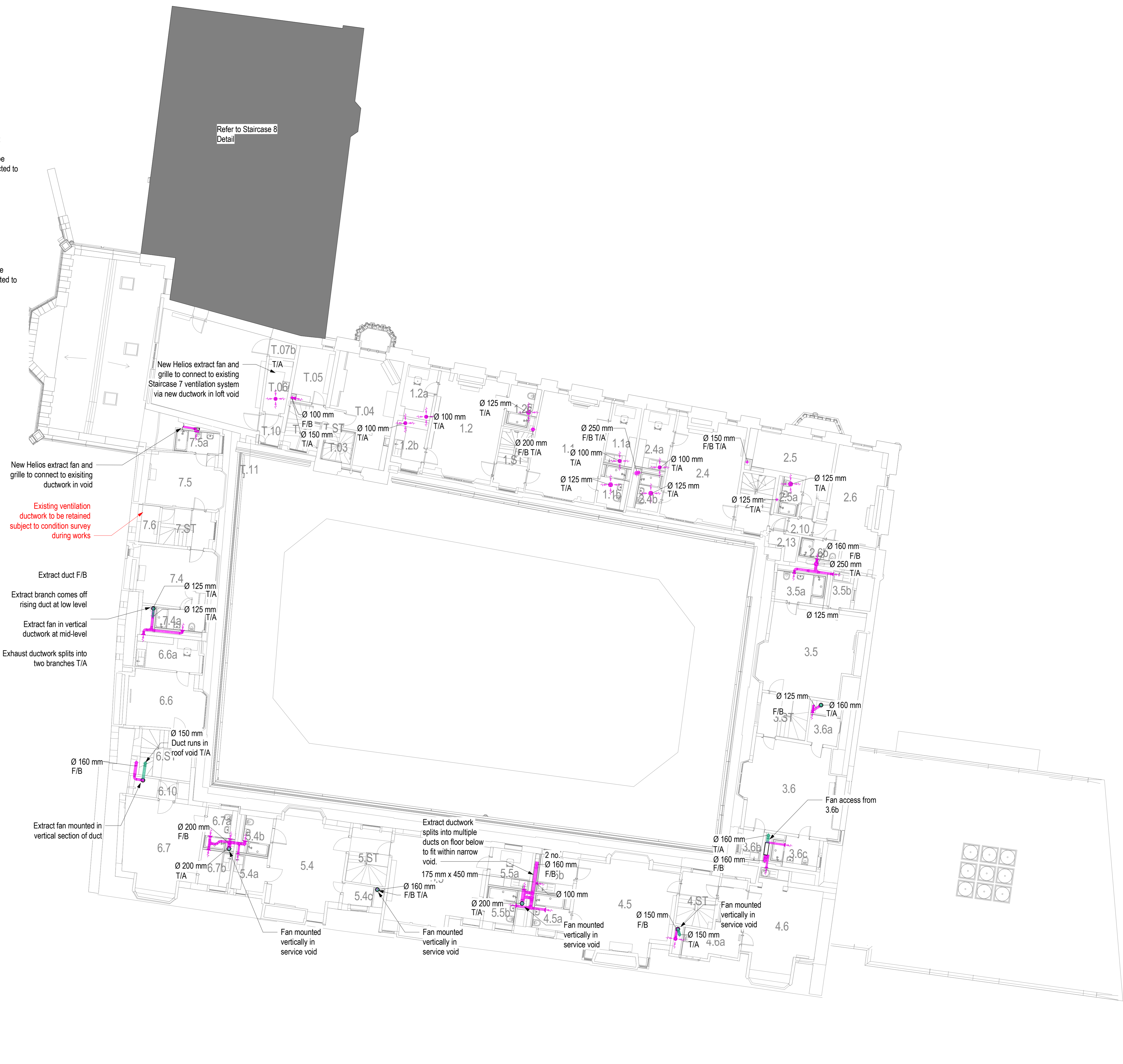
1 500 - Ventilation - Level 02 - Old Quad 1 : 100
