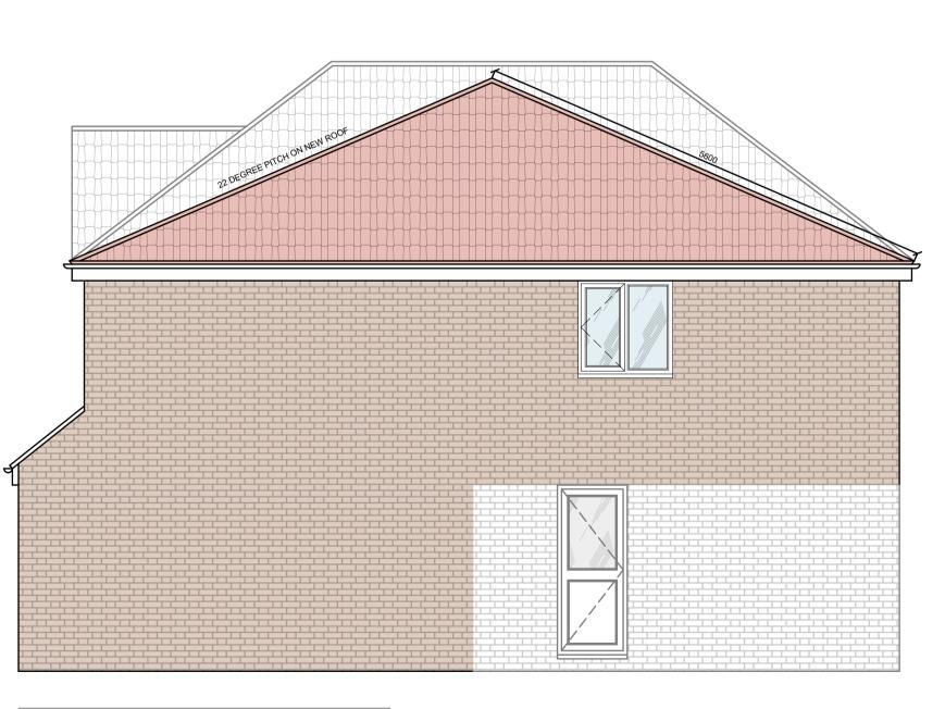
PROPOSED RIGHT SIDE ELEVATION SCALE 1:50
